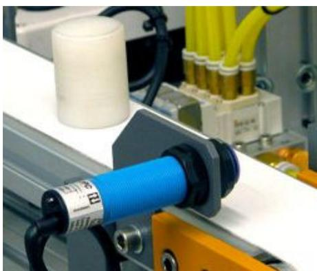
Nel caso in cui invece l'oggetto rilevato è di tipo metallico, viene subito attivata una guida attraverso l'attivazione del solenoide dell'elettrovalvola **YV1**, non appena l'oggetto raggiunge la posizione di allineamento con la guida, un sensore fotoelettrico **S6** rileverà la presenza dell'oggetto quindi arresterà il nastro trasportatore **NASTRO\_1** e
